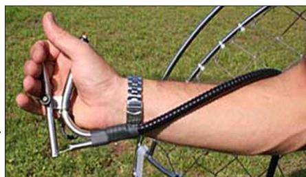
Sur la poignée vérifier également que la roulette de blocage de gaz soit desserrée et que la poignée de gaz revienne (1). Au dessus vous avez le bouton d'arrêt (2).
