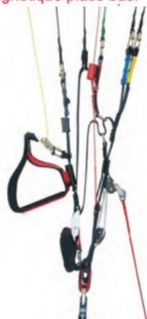
Figure 3 point d'attache haut (ligne de frein passant à travers une poulie en position basse). Clip magnétique placé bas.
