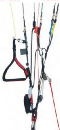
Figure 2 point d'attache bas (ligne de frein passant à travers une poulie en position haute). Clip magnétique placé haut.
