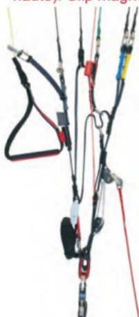
Figure 2 point d'attache bas (ligne de frein passant à travers une poulie en position haute). Clip magnétique placé haut.
